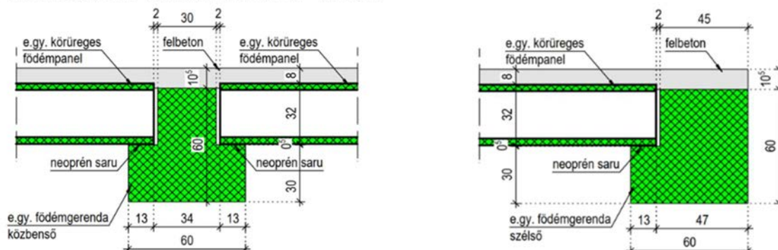
91. ábra: Körüreges födémpanelek és mestergerendák kapcsolat típusai
