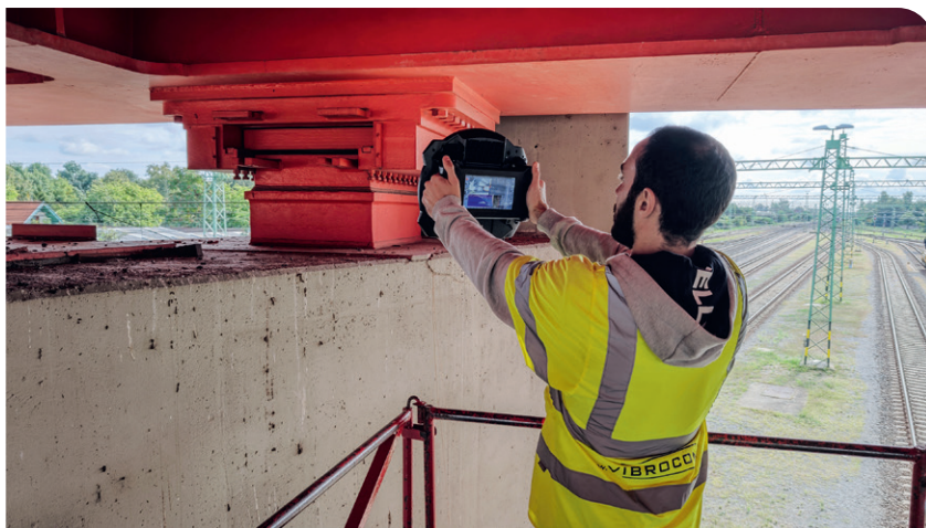
7. ábra: Az egy irányban elmozduló saru akusztikus vizsgálata
