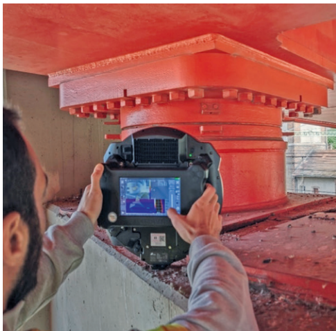
6. ábra: Fix saru akusztikus vizsgálata
