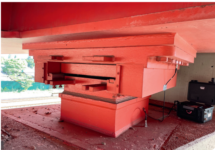
8. ábra: Rezgésmérés az egy irányban elmozduló sarun kijelölt mérési pontokban (nézet nyugat felől)
