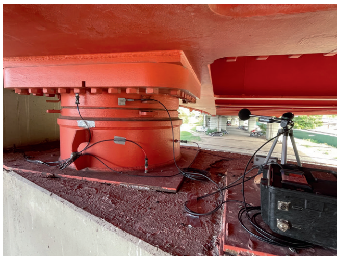
7. ábra: Az egy irányban elmozduló saru akusztikus vizsgálata
