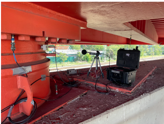
7a-b ábra: Zaj- és rezgésmérés a fix sarun kijelölt mérési pontokon (nézet nyugat felől)
