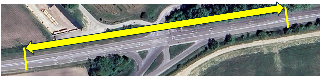
5. ábra Csomóponti szakasz képzése főúti kanyarodósávok esetén
