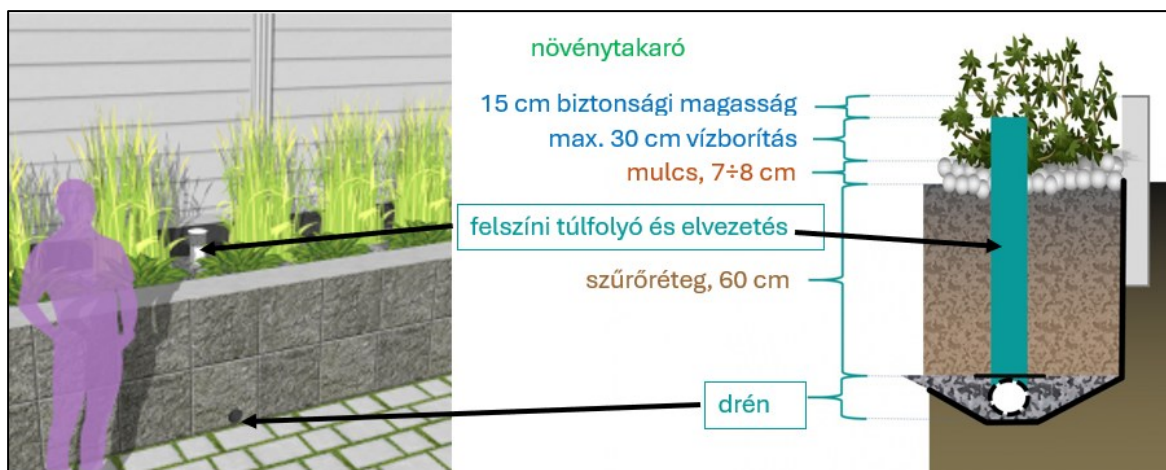
10. ábra: növényes vályú és vízáteresztő burkolat kombinációja
