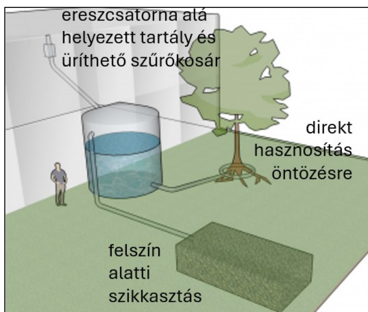
26. ábra Csapadékvízgyűjtés, szikkasztással
