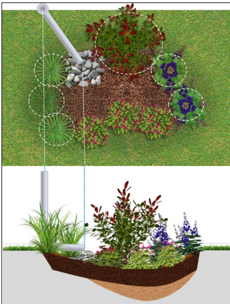
4. ábra: egyszerű esőkert a tetőről lefolyó víz befogadására és beszivárogtatására
