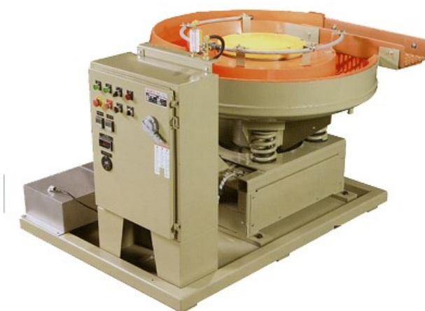
5.17. ábra. Rezgő sorjázó (finiselő) berendezés ( www.tekdeburr.com ) és az Eltérő méretű és formájú abrazív kerámia szemcsék sorjázó töltelék részek [ www.best-b2b.com ]
