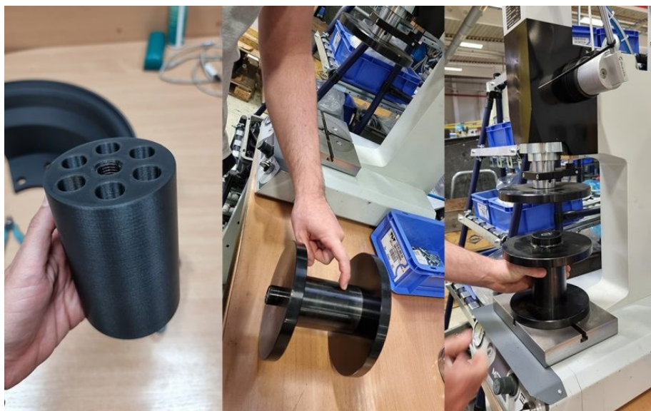
3.Melléklet-4. ábra. Kompozit 3D nyomtatással készült présalátét [forrás: Szabó Péter, FreeDee Printing Solutions]
