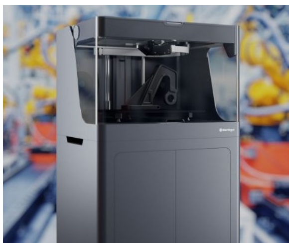
3.Melléklet-1. ábra. A Dana Hungary Off-Highway gyárában jelenleg 80%-os kihasználtság fölött dolgozik a Markforged X7 nyomtató [106]
