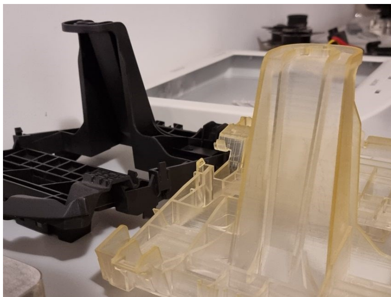
5.Melléklet-3. ábra. 3D nyomtatott mesterdarab és vákuumöntött alkatrész egymás mellett [forrás: Szabó Péter, FreeDee Printing Solutions]
