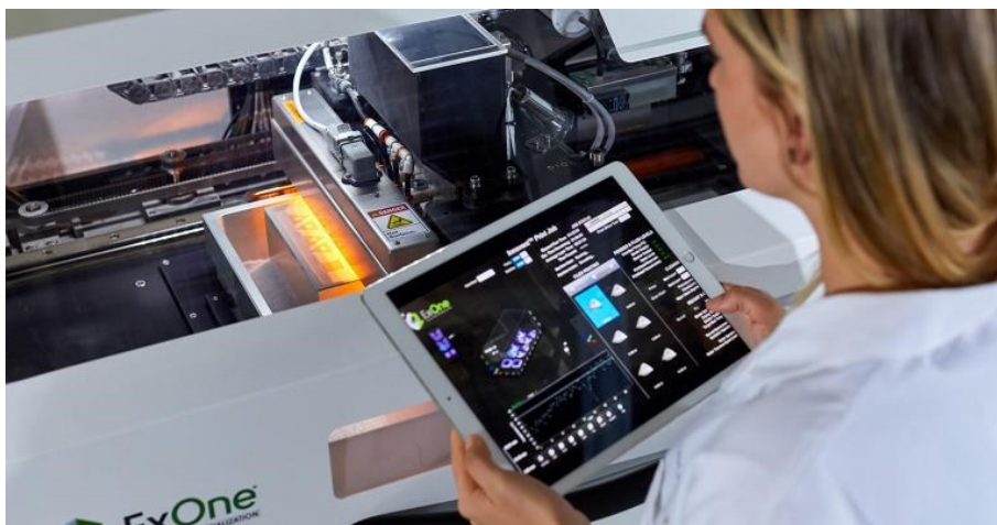
5.20. ábra. Nyomatási paraméterek monitorozása az ExOne fémnyomtató rendszeren [79]
