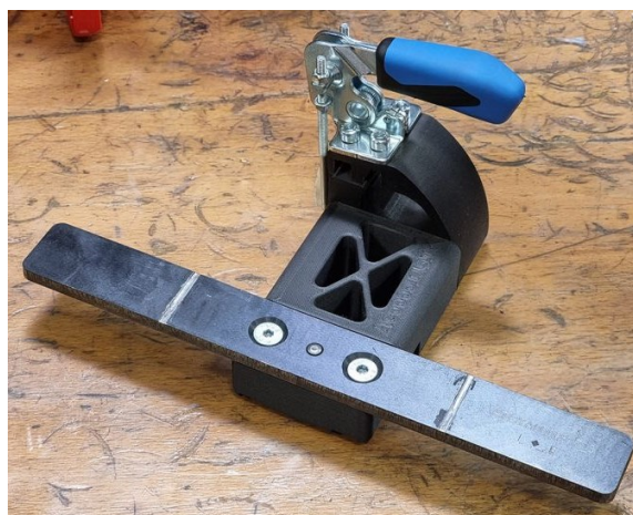
3.Melléklet-6. ábra. Foghézag mérésére használt alkatrész nyomtatott és fém részekkel [forrás: Szabó Péter, FreeDee Printing Solutions]
