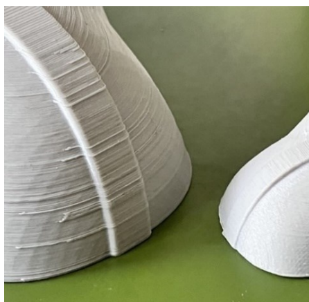
4.10. ábra. Azonos modellek eltérő méretarányú 3D nyomtatott termékei, a bal oldalon nagy méretben 0,25mm-es, a jobb oldalon ugyanaz a modell kicsinyített 0,06mm-es rétegvastagsággal láthatók [forrás: fotó, Zsidai László]
