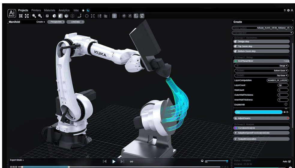
5.28. ábra. Folyamatfigyelés és visszacsatolás gépi tanulással az AiBuild rendszerben [87]
