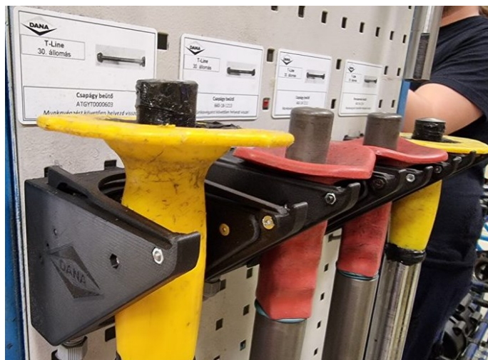
3.Melléklet-2. ábra. Nyomtatott szerszámtartó kampók jeladóval [forrás: Szabó Péter, FreeDee Printing Solutions]
