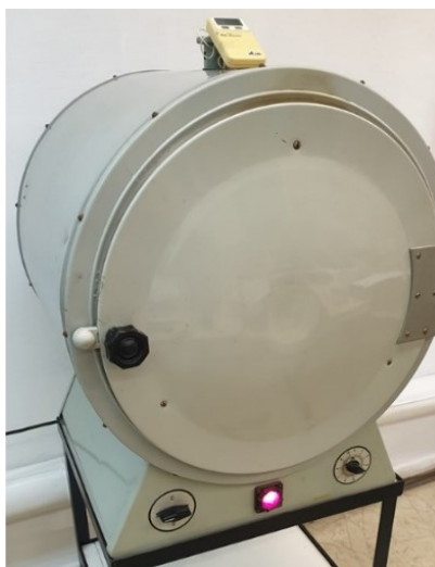
5.14. ábra. Szárítókamra, anyagvizsgálati célú próbatestek kondicionálására [forrás: MATE-MI, Gödöllő, Additív technológiai labor]
