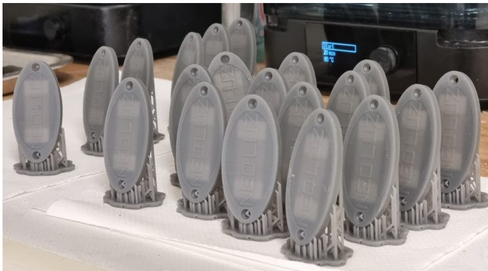
5.Melléklet-5. ábra. Kisméretű, nyomtatott dekorelemek Grey Pro műgyantából a Technoplast üzemében [forrás: Szabó Péter, FreeDee Printing Solutions]
