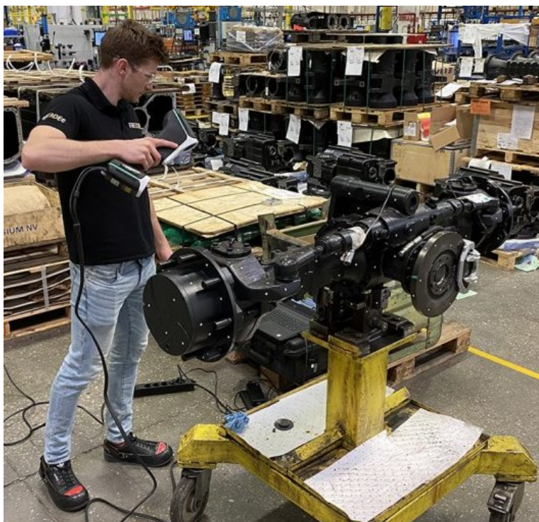
3.Melléklet-13. ábra. Futómű 3D szkennelése a Dana Hungary OH gyárában [forrás: Szabó Péter, FreeDee Printing Solutions]
