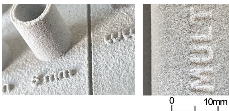
4.25. ábra. Eltérő méretarányú SLS nyomtatott domborítások és hornyok minősége, [forrás: fotó, Zsidai László]
