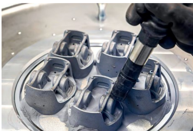
3.16. ábra Alumíniumból készült 3D nyomtatott dugattyúk Porsche 911 GT2 RS sportautóba [42]
