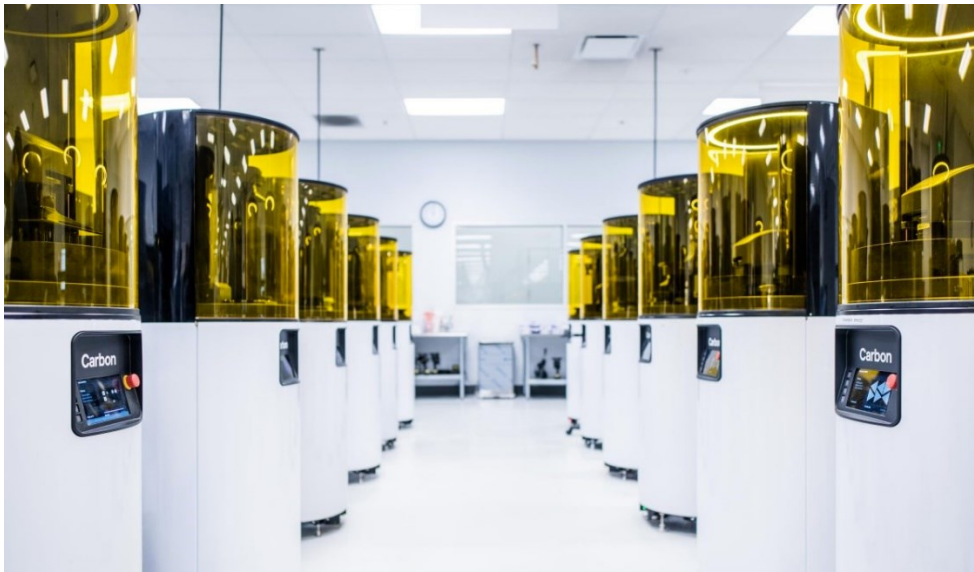
6.15. ábra. Tömegesen személyre szabható cipőtálpak gyártására optimalizált műgyantás nyomtatófarm [99]
