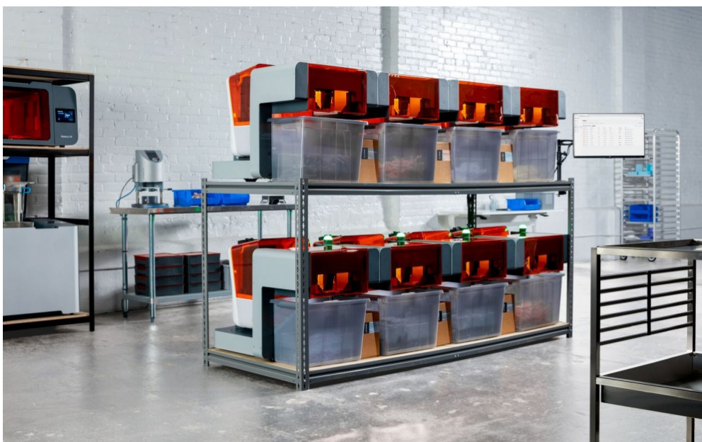
6.16. ábra. Formlabs Form Auto automatizált sorozatgyártó 3D nyomtató farm [100]
