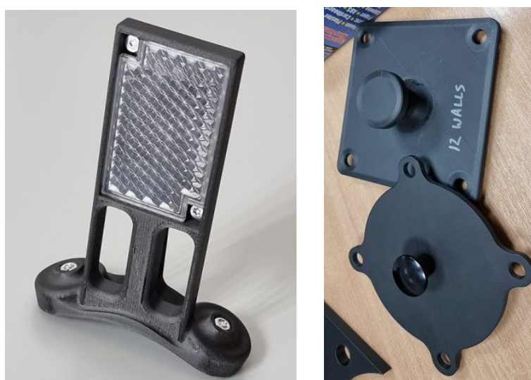
3.Melléklet-3. ábra. Nyomtatott prizmatartó a bal oldali és a tesztfedelek a jobb oldali ábrákon [forrás: Szabó Péter, FreeDee Printing Solutions]
