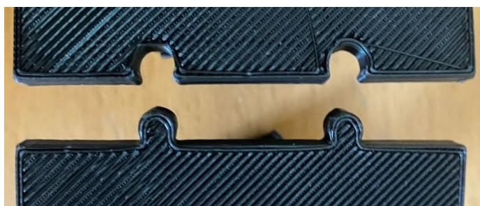
4.68. ábra Egymásba pattintható dugós-körmös FDM nyomtatott lap kapcsolódás [forrás: fotó, Zsidai László]
