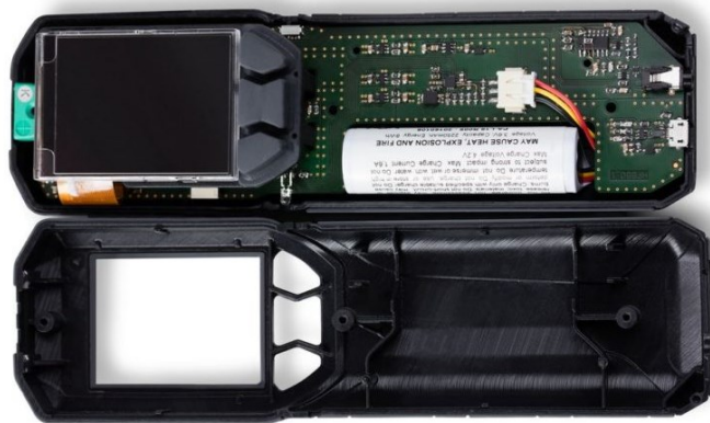
4.Melléklet-1. ábra. Form 2 asztali SLA nyomtatóval készült készülékház és billentyűzet prototípus [107]
