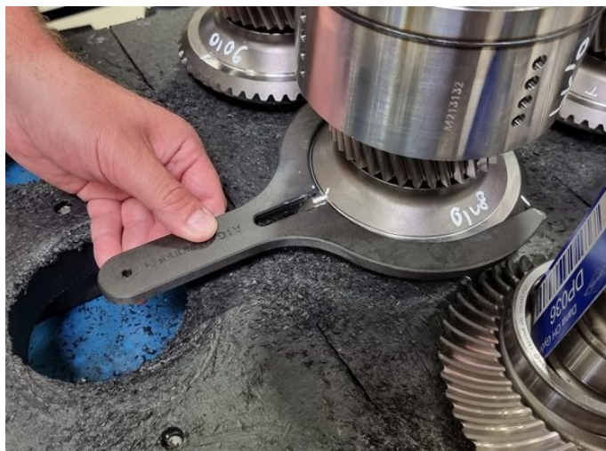
3.Melléklet-8. ábra. Tányérkerék foghézagjait ellenőrző szerszám – ez a nyomtatott eszköz pontosan 120 fokra osztja az operátornak a kereket [forrás: Szabó Péter, FreeDee Printing Solutions]
