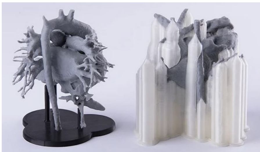
3.9. ábra Bonyolult geometria támasztása PVA filament használatával [25]
