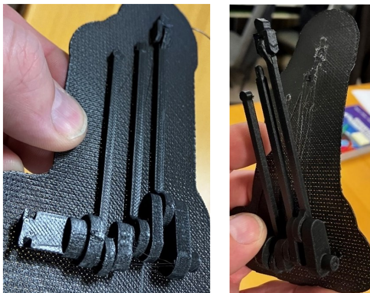
4.71. ábra Benzülött hármashajtókar egység (bal oldal) és leválasztása az alaplapról (jobb oldal) amelyet maximális felület illeszkedéssel terveztek, [forrás: fotó, Zsidai László]
