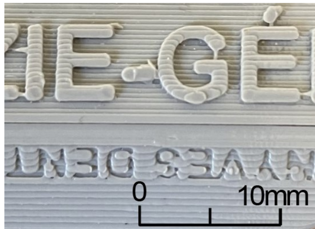
4.23. ábra FDM nyomtatott domború és hornyolt szöveg azonos méretarányban, [forrás: fotó, Zsidai László]
