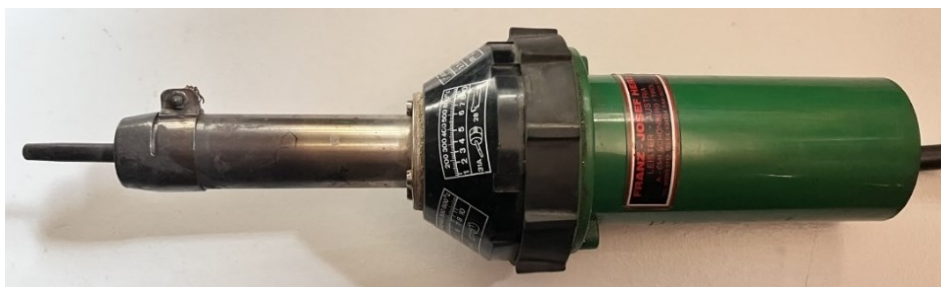
5.13. ábra. Ipari hőlégfúvó (Leister) műanyag hegesztéséhez [forrás: fotó, Zsidai László]
