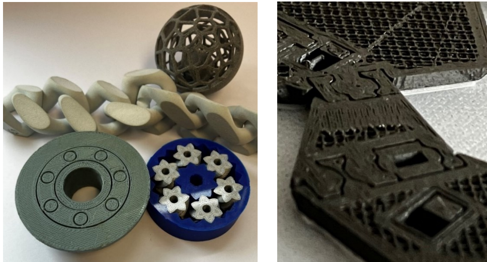
4.70. ábra Egybe nyomtatott bennszülött alkatrészek (bal kép) komplex csukló mechanizmus félig kinyomtatott állapotban (jobb kép), [forrás: fotó, Zsidai László]
