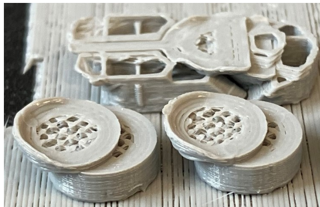
5.8. ábra. Az alappal kis felületen érintkező, a nyomtatás közben eldőlt kúpos alkatrész (bal) és a nyomtatás közben levált és elcsúszott hengeres alkatrész (jobb) nyomtatási hibái [forrás: fotó, Zsidai László]
