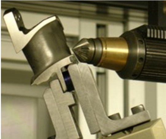
5.18. ábra. Példák az iparban alkalmazott sorjázó marókra: Sorjázás szabályos élű (sorjázó) maróval (bal), [www.acmemfg.com], sűrített levegővel hajtott marófej (jobb), [news.thomasnet.com]
