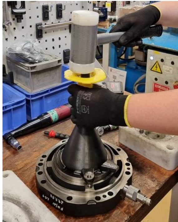
3.Melléklet-11. ábra. Nyomtatott csapágybeütő – könnyebb, mégis erős szerszámok kompozit 3D nyomtatással [forrás: Szabó Péter, FreeDee Printing Solutions]
