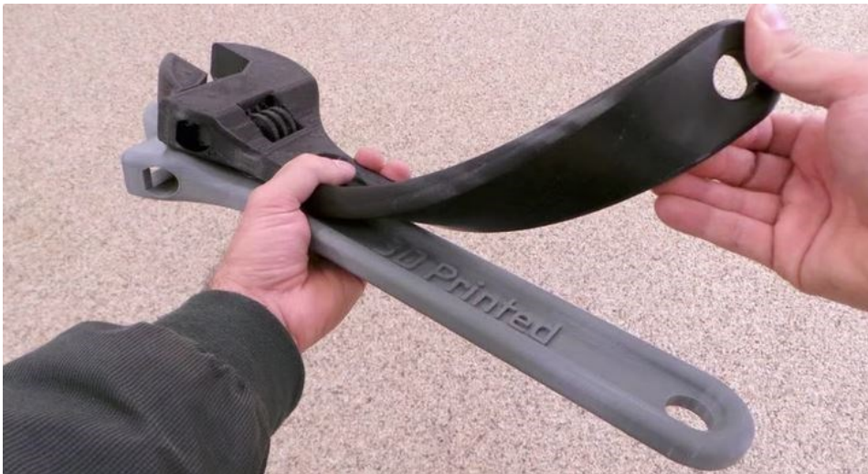
3.4. ábra TPE anyagból nyomtatott tárgy rugalmasságát szemléltető ábra [8]
