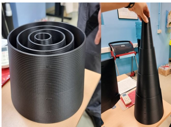
3.Melléklet-9. ábra. O-gyűrű ellenőrző sablon, amellyel 40-től – 220 mm-ig tudnak ellenőrizni [forrás: Szabó Péter, FreeDee Printing Solutions]
