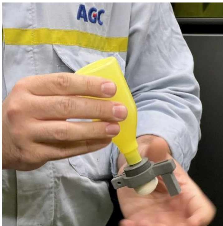
2.Melléklet-2. ábra. A nyomtatott fejen egy távtartó is segíti a pontos használatot [105]
