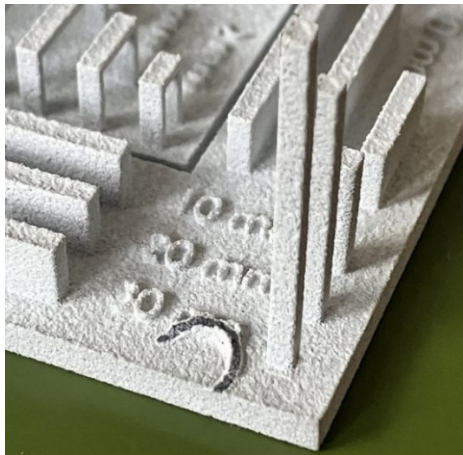
4.28. ábra. SLS (bal) és SLA (jobb) technológiával készült kisméretű geometriai részletek, [forrás: fotó, Zsidai László]
