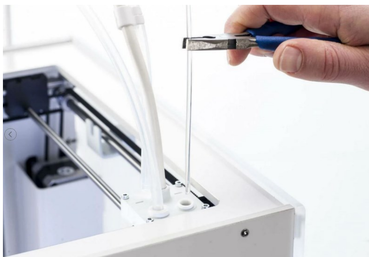
3.10. ábra Cleaning filament kézi befűzése tisztítás közben [27]
