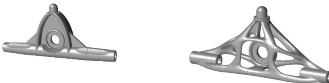
4.78. ábra. Tartószerkezeti csomópont kikönnnyítése az Altair szoftverben [68]
