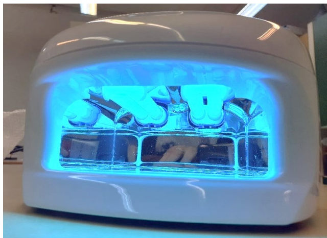
5.15. ábra. UV fény kezelő kamra DLP próbatestek kikeményítése közben [forrás: MATE-MI, Gödöllő, Additív technológiai labor]
