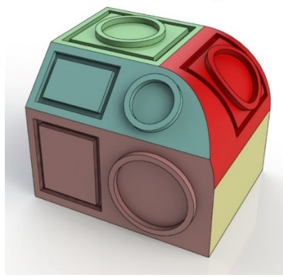
4.22. ábra Keskeny domború kiemelkedések és (vésett) hornyok előnyös és előnytelen elhelyezése a munkadarab eltérő sík oldalain és ívelt felületein (kedvező zöld, kedvezőtlen piros és elfogadható kék színjelzésekkel)
