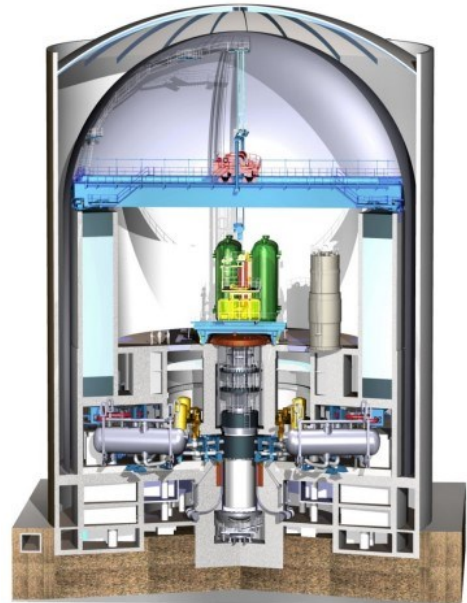
8.3. ábra: Kettősfalú konténment ([22])
