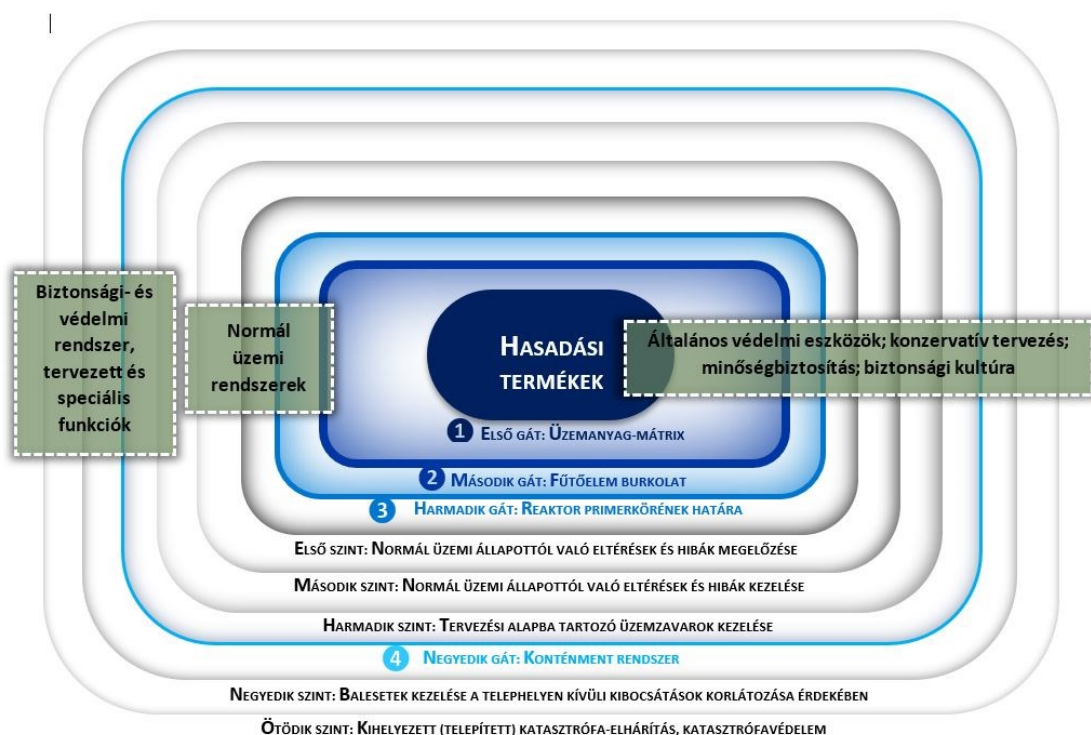
14.5. ábra: Fizikai gátak és védelmi alapelvek, a mélységben tagolt védelem szintjei közötti kapcsolat (IAEA (1999) Fig. 4.; N3a.35 (2019) 3.1 alapján)
