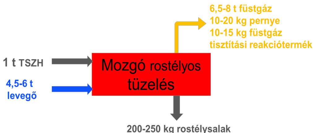
18. ábra. A hulladékégetés anyagmérlege száraz és félszáraz füstgáztisztítás mellett
