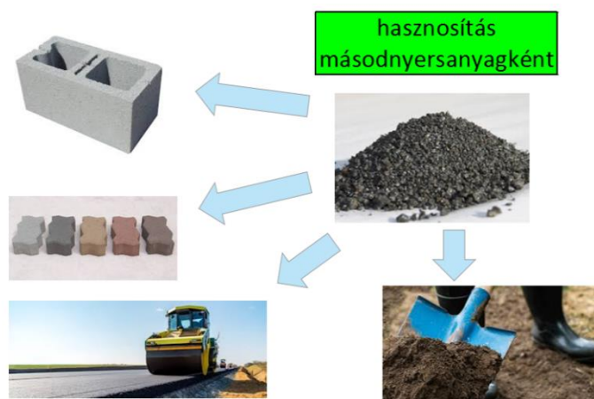
52. ábra. Salak hasznosítása másodnyersanyagként: térkő, építőblokk alapanyagaként, útépitésben, talajjavító anyagként
