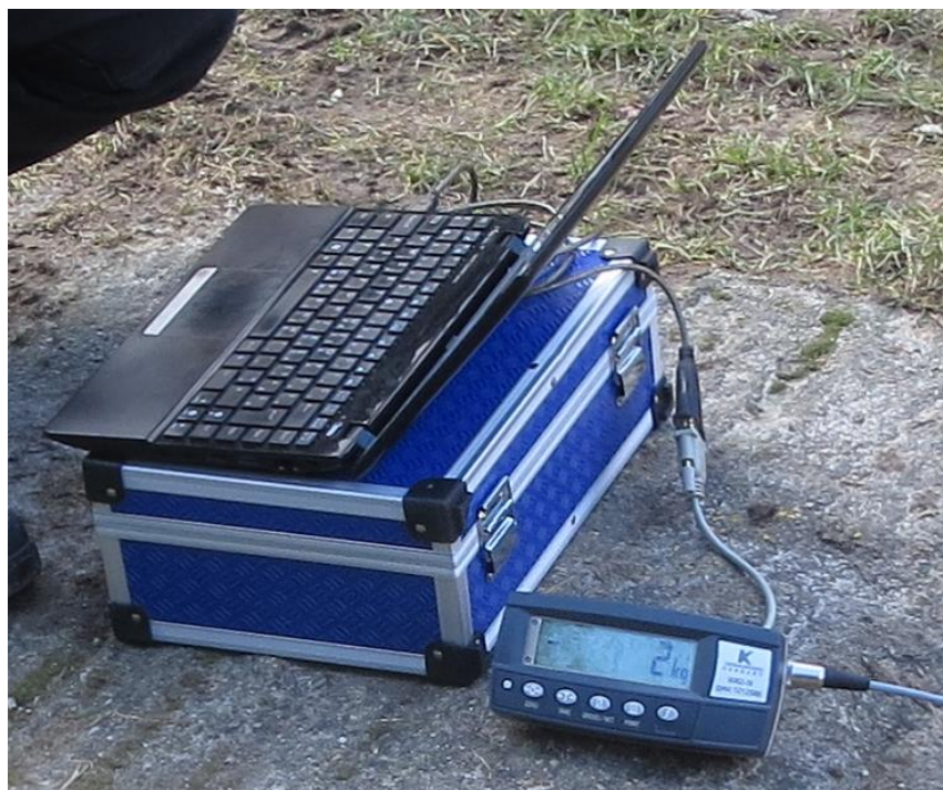
6. ábra Az erőmérő kijelzője USB-soros kábelén csatlakozik a számítógéphez. Alternatív kapcsolódási lehetőség: Bluetooth.
