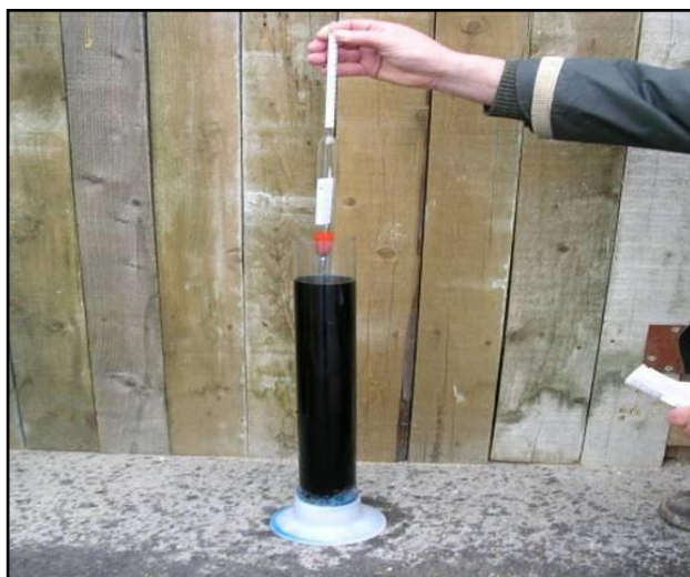
28. ábra A koncentráció meghatározása areométerrel (Király B.)
