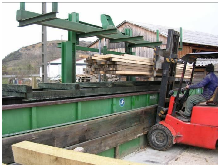
31. ábra. Automatavezérlésű, kettősfalú áztatókád (Király B.)
