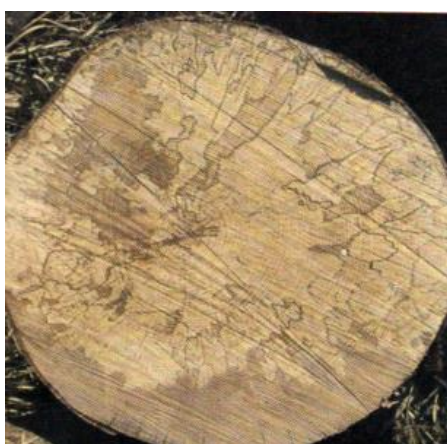
7. ábra Bükk rönk fülledése
