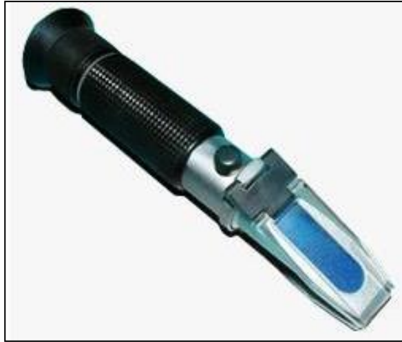
29. ábra A koncentráció meghatározása szolgáló kézi refraktométer ( www.weszt.hu )
