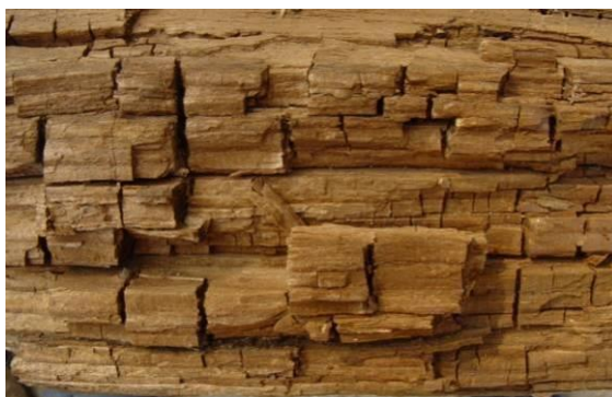
9. ábra Barna korhadást okozó gomba által bontott, köbösen repedezett, porló faanyag
