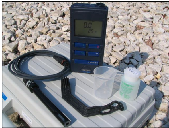
30. ábra Vezetőképesség változását mérő műszer (Babos R.)
