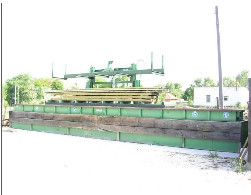
34. ábra. Kettősfalú, programvezérlésű gépi áztatókád (Király B.)
