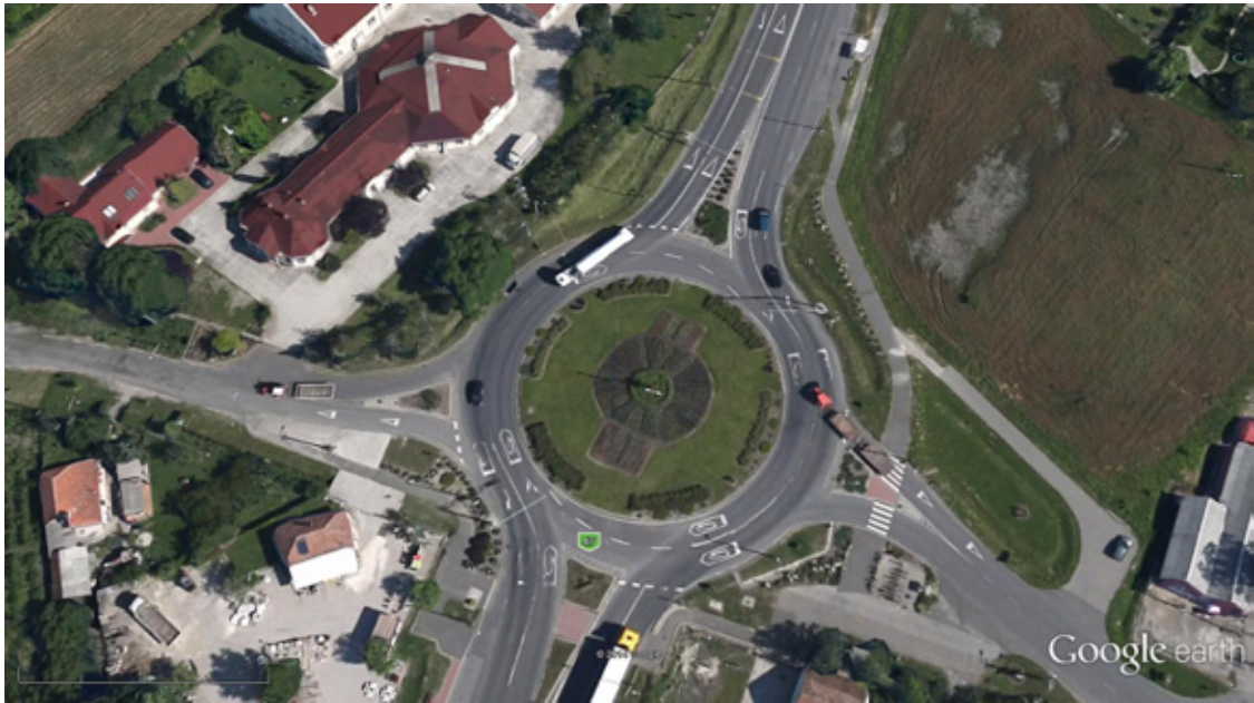
Az M43 autópálya és a négysávós 47 sz. főút csomópontja Szegedtől É-ra, két darab holland turbó csomóponttal, mint alcsomópontokkal.
