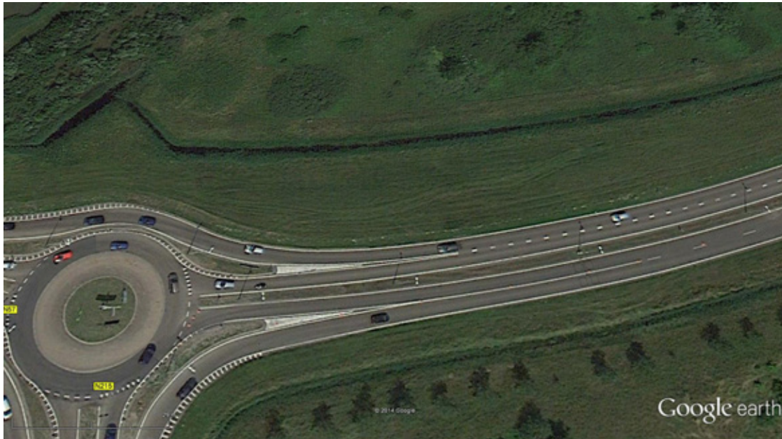
Korteven-től D-re N289 3-ágú turbó körforgalom, két sávos be- és kilépőkkel
