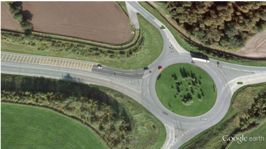
Iminster-től Ny-ra (A303-B3168) A három sávós út kezdő csomópontja, koncentrikus kör festéssel a gyűrűben:
