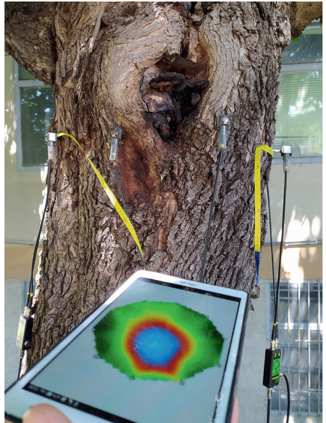
Műszeres favizsgálat akusztikus tomográfal
