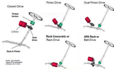
4. ábra: Az elektromos kormányrendszerek legfőbb típusai. Zöld színnel a vezető által kifejtett kormányzási nyomaték (közvetett) mérésére szolgáló nyomatékszenzor, míg pirossal a ráségítést végző elektromos szervomotor látható
