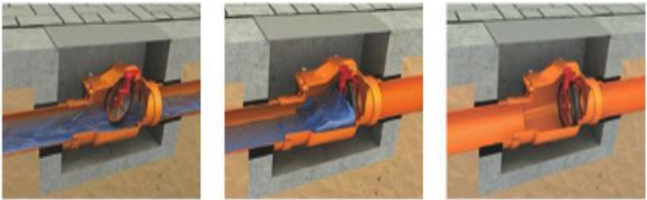
Visszacsapó szelep működése
