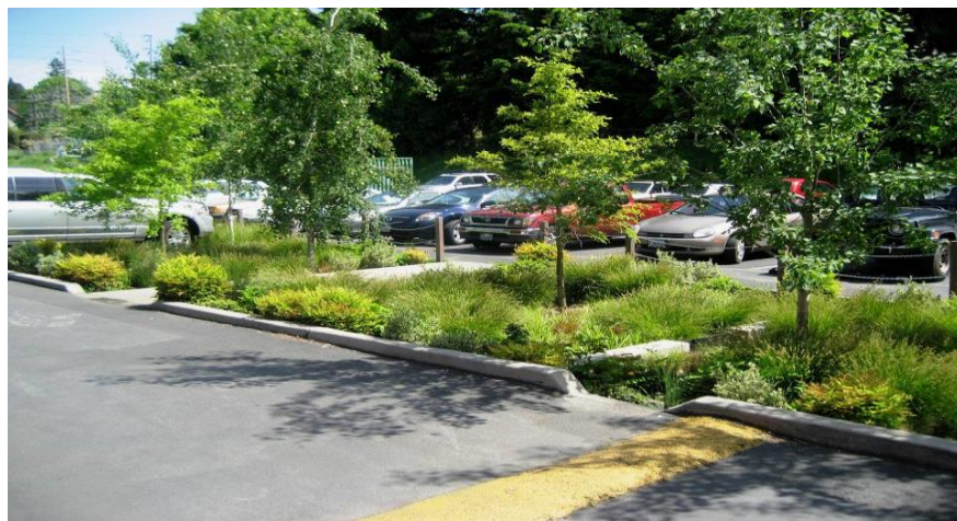
Parkolók lefolyásának bevezetése füvesített vagy kavicsöltésű szivárogtató árkokba
