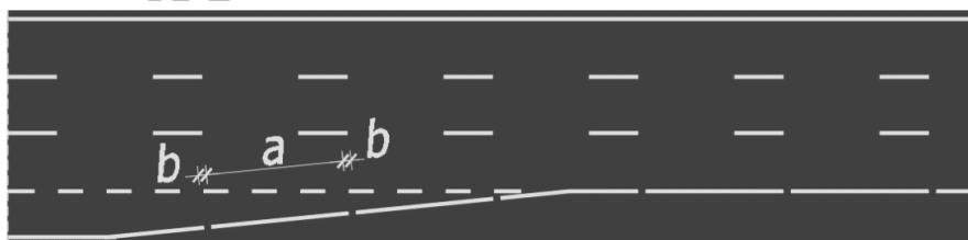
2. ábra: különleges-időszakos burkolati jel alkalmazása (példa).
