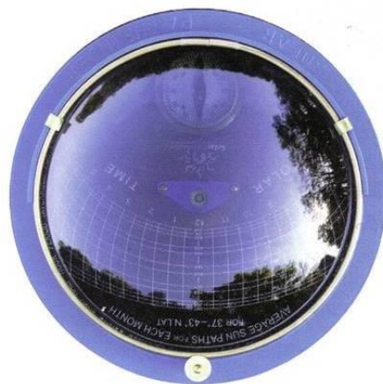
6.17. ábra: Égbolt láthatóság és nappályák kördiagramban és halszemoptikás felvételen [16]
