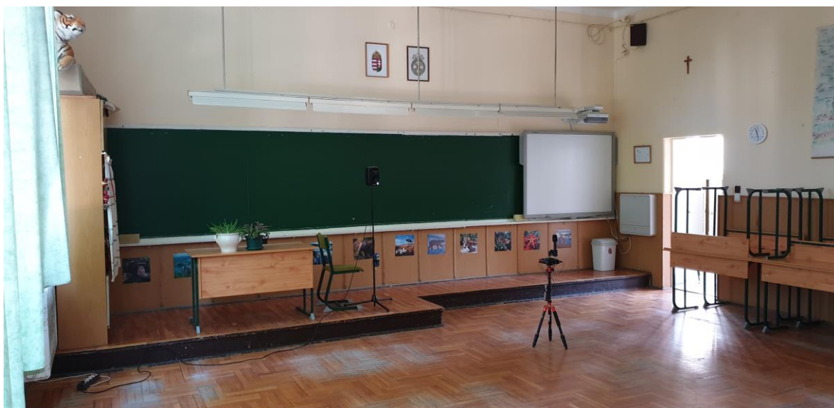
4-2. fotó: Egy teremakusztikailag kezeletlen 4,2 m magas középiskolai tanterem (példa, 8,8×7,8×4,2 m méretekkel).
